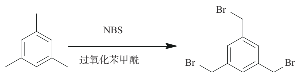
图1 1,3,5-三(溴甲基)苯的合成路线
